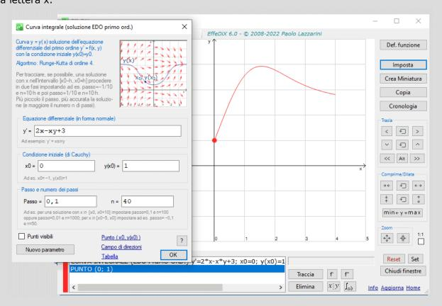
Volendo una soluzione più accurata potremmo impostare un passo di 0,01 e un numero passi pari a 400. Tracciamo poi la soluzione con passo negativo uguale a -0,1 e 40 passi in modo che x, il cui valore iniziale è  $x_0$ =0, vari da 0 a -4. Nella schermata seguente vedete il grafico della soluzione nell'intervallo [-4, 4].
